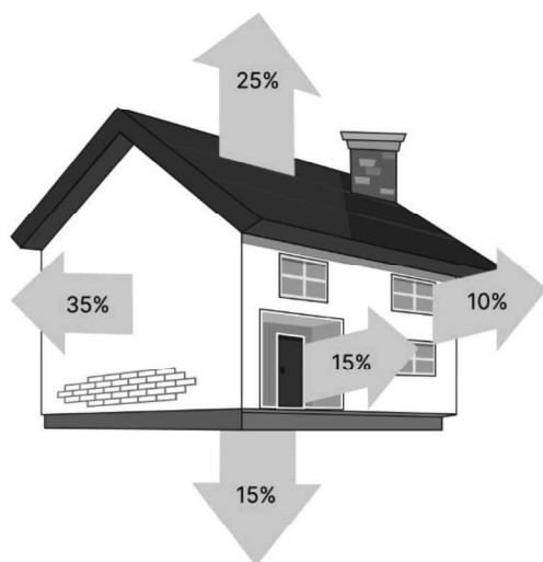
Рис. 5. Структура енерговтрат будівлі
