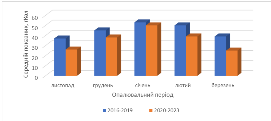
Рис. 1. Різниця споживання тепла в ОСББ до заміни системи тепlopостачання (2016-2019 рр.) та після заміни системи тепlopостачання (2020-2023 рр.), гКал
