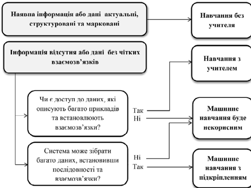
Рис. 1. Узагальнений алгоритм застосування машинного навчання
