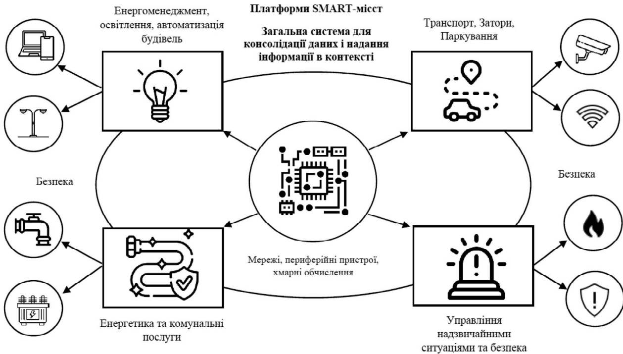
Рис. 1. Система платформи smart-міст
